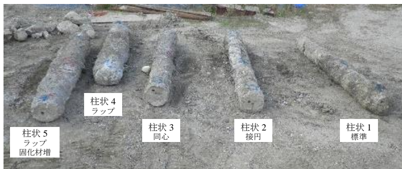
写真2 掘り起こした柱状改良体
