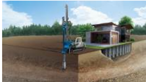
自然碎石を使用した『エコジオ工法』のイメージ図
