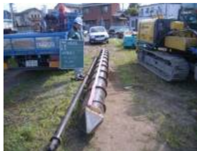
通常の10分の1の小型ケーシングの実験用試作モデル
